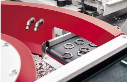
Die Werkstücke – hier Teile eines anderen Kunden – werden über ein Förderband von der Seite zugeführt / The work pieces – the photo shows parts of another customer – are transferred into the machine from the side with a conveyor belt
